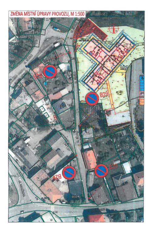
Změna místní úpravy provozu na PK je vyvolána požadavkemm HZS. Úprava spočívá v osazení 4 x DZ č. B29 "Zákaz stání" od křižovatky MK ul. Rudé Armády - ul. Bělidlo a to v celé délce MK. Provední dle situace.
